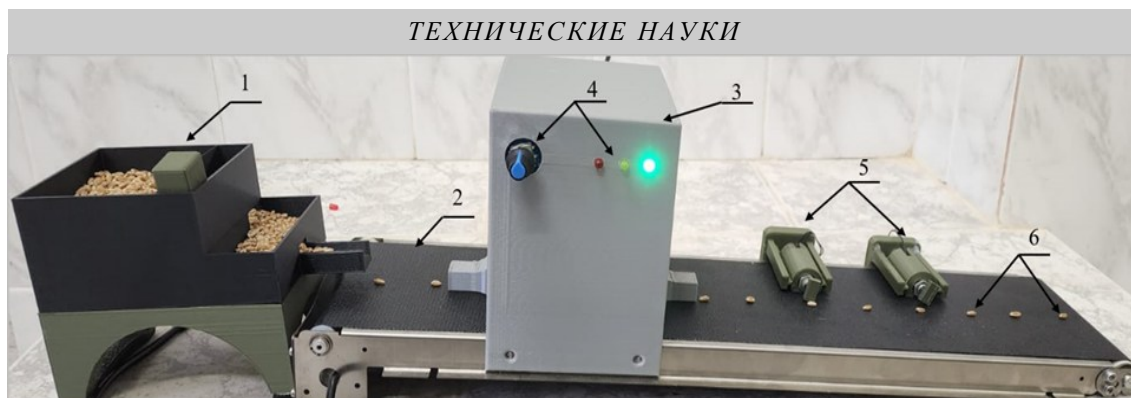
Рис. 5 – Общий вид устройства фотолуминесцентной сепарации семян зерновых культур, зараженных фузариозом: 1 – бункер-накопитель, 2 – транспортерная лента, 3 – оптоэлектронный блок, 4 – потенциометр (вкл./выкл. и частота подачи) индикация (зеленый-здоровое зерно, красный-некондиционное, желтый-неопределённое), 5 – соленоиды, 6 – зерно
