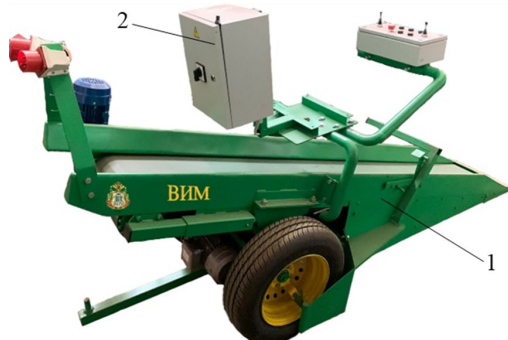
Рис. 1 – Общий вид автоматизированной машины для закладки на хранение картофеля:
