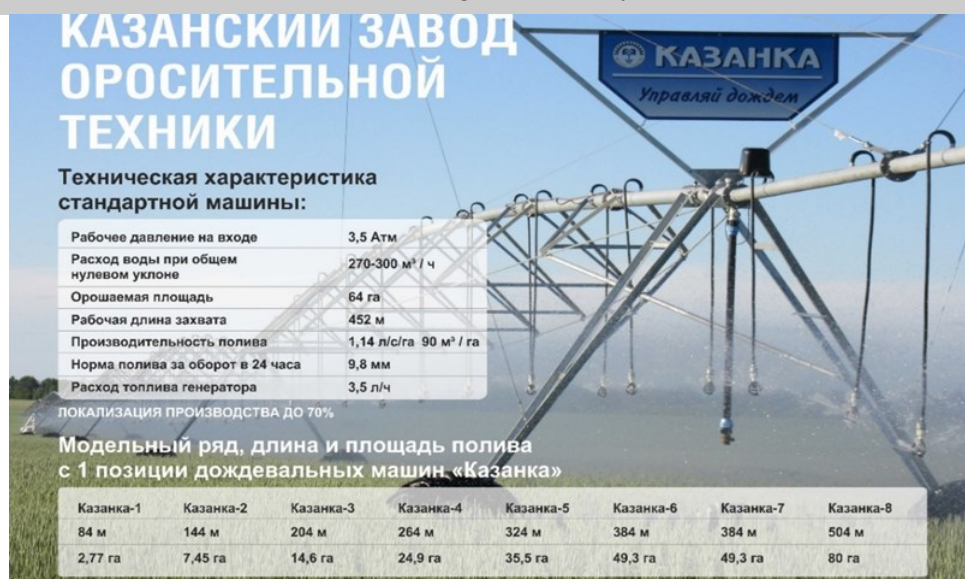
Рис. 3 – Широкозахватная дождевальная машина кругового действия типа «Казанка»
