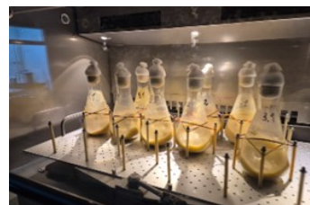
Рис. 2 - Ферментативный гидролиз в лабораторном шейкере-инкубаторе
