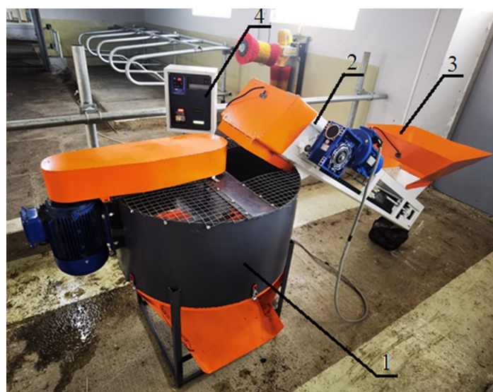
Рис. 3 - Разработанный измельчитель кормов при проведении лабораторных исследований: 1 – измельчитель кормов, 2 – транспортер, 3 – загрузочный бункер, 4 - пульт управления
