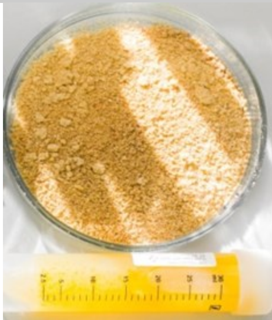
Рис. 3 – Экструдированный люпин после ферментативного гидролиза и сушки, гидролизат (надосадочная жидкость)
