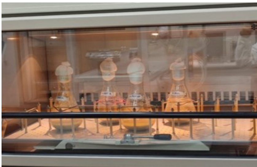
Рис. 2 – Ферментативный гидролиз в лабораторном шейкере
