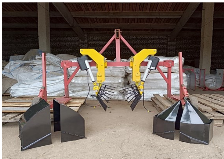
Рис. 6 – Общий вид манипулятора автоматизированной машины для удаления из почвы зараженных растений картофеля и овощных культур
